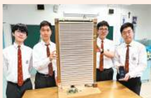
◆智慧百葉簾「CurTaIn」具備傳統百葉簾的通風和調光功能，用家更可通過手機應用程式遠程控制窗簾開關。 香港文匯報記者姜嘉軒攝
