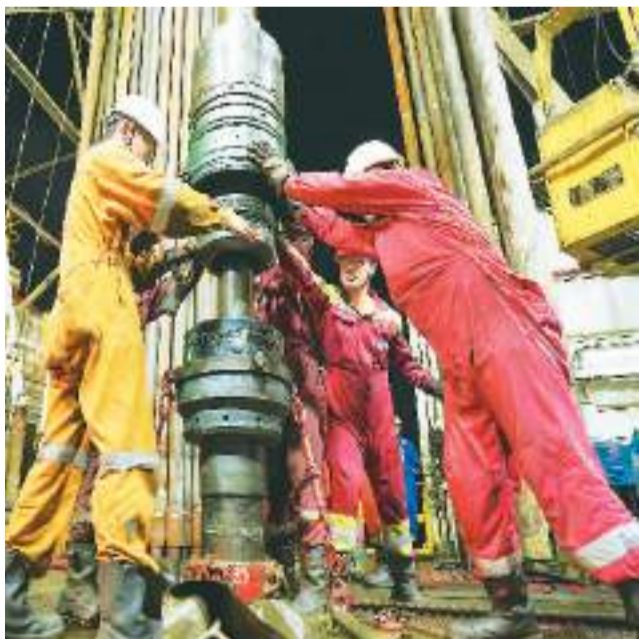
一体式水下井口关键部件组装场景。
