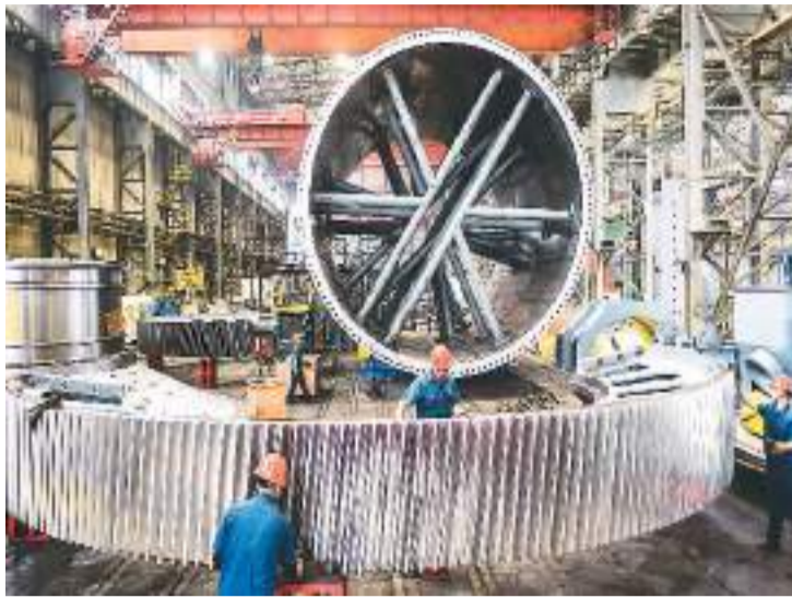
河南省洛阳市大力发展装备制造产业，装备制造规模化、集约化发展水平不断提升，助力当地经济高质量发展。图为日前，工人在位于洛阳市的中信重工车间内装配吊直径6米的矿用大磨机。
