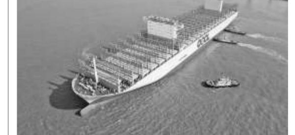
5月7日,“中远川崎397”集装箱船出海试航(无人机照片)。当日,由江苏南通中远海运川崎船舶工程有限公司自主设计、研发制造的“中远川崎397”集装箱船出海试航。该船长399.99米、型宽61.3米,型深33.2米,可装载24188个国际标准集装箱。
